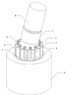
图示：1.钢铸连接器；2.钢铸连接板；3.圆环形连接件；4.基础预埋件；5.环向基础预埋螺栓；6.加筋肋；7.法兰底板；8.桅杆；9.基座。
